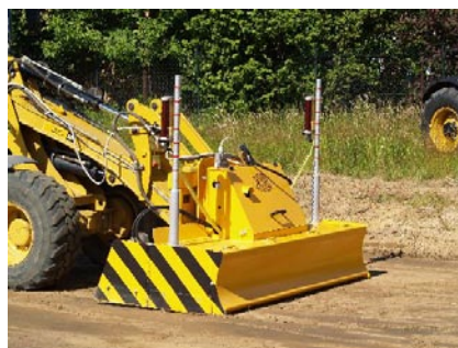
System leveller na koparkoladowarce. Na pierwszym planie niwelator laserowy
