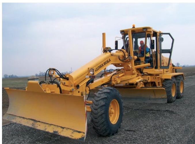
Równiarka z zainstalowanym systemem Topcon 2D (Sonic)
