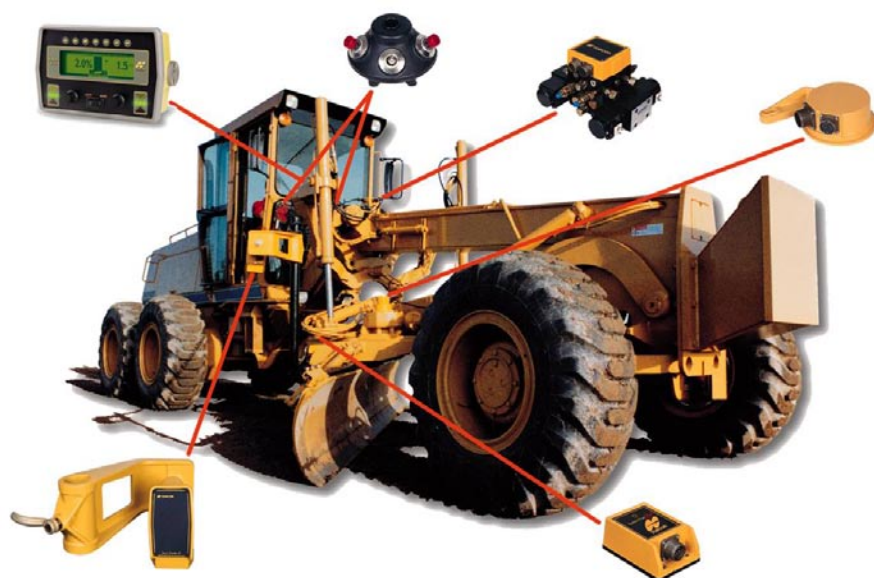
Poszczególne elementy składowe systemu Topcon 2D (Sonic) montowane na maszynie
