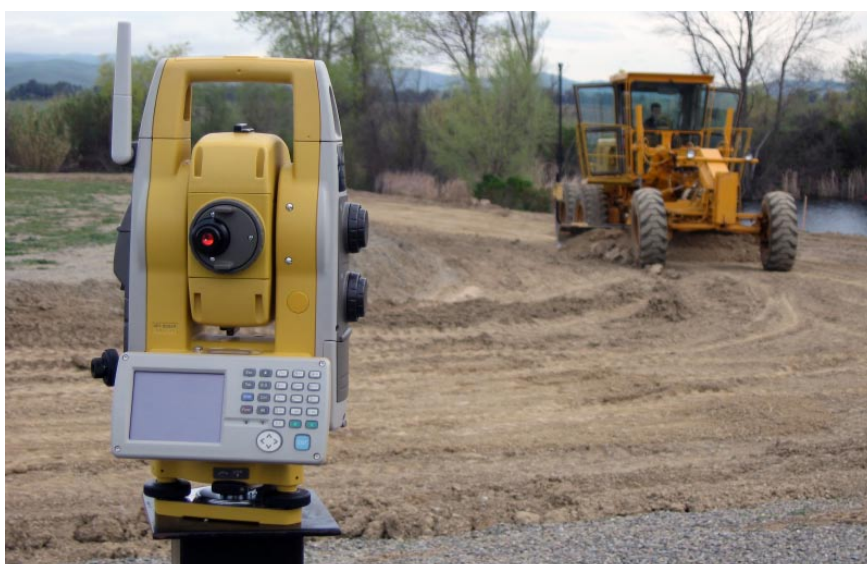
Precyzyjny tachimetr Topcon wykorzystywany do wyznaczania pozycji maszyny
