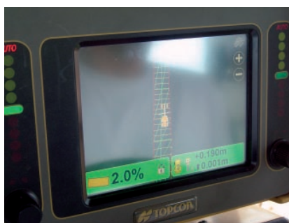
Dotykowy panel sterujący systemem Topcon 3D LPS
