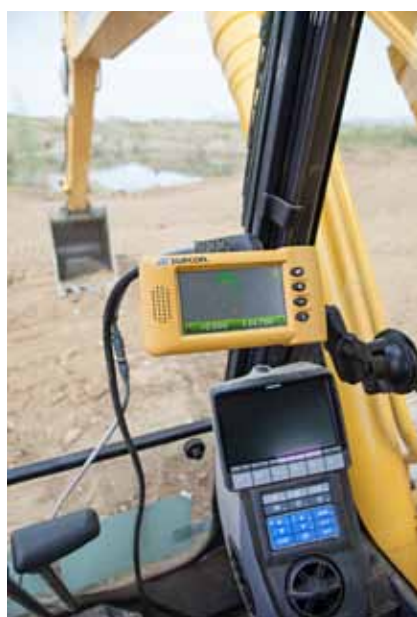
Komputer kabinowy systemu Topcon X-33 – precyzyjna nawigacja wykonywanych prac
