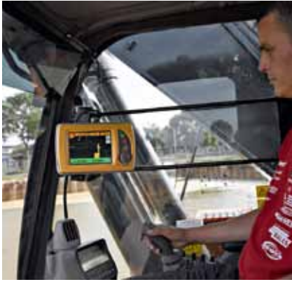
Komputer kabinowy systemu Topcon X-63i umożliwia wyświetlanie trzech widoków jednocześnie
