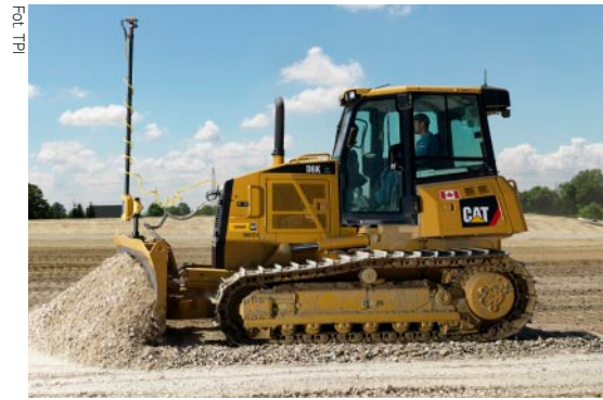
System Topcon 3D mc2 – najnowocześniejszy i najbardziej wydajny system na rynku do sterowania pracą spycharki
