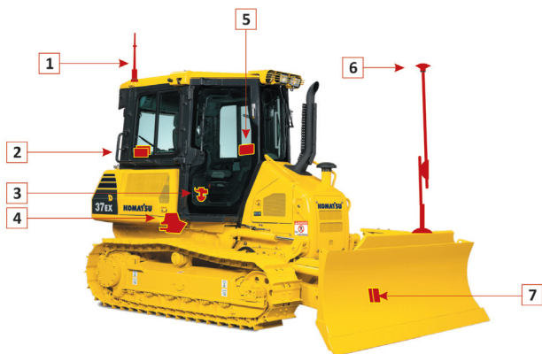
Elementy systemu 3D MC 2 firmy Topcon: 1) Antena radiowa, 2) Odbiornik GPS + Glonass, 3) Wyłącznik trybu automatycznego, 4) Zawory hydrauliczne i siłownik sterujący hydrauliką maszyny, 5) Panel sterujący 3D, 6) Antena GPS + Glonass, 7) Czujnik inercyjny 3D MC 2
