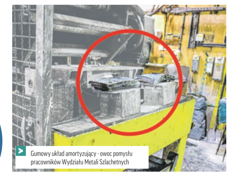
Gumowy układ amortyzujący - owoc pomysłu pracowników Wydziału Metali Szlachetnych
