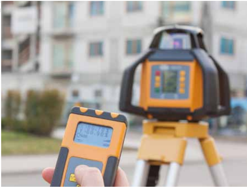
Nowe niwelatory mają możliwość zdalnej obsługi za pomocą pilota z wbudowanym wyświetlaczem LCD
