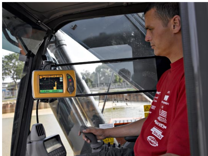
Wszystkie parametry pracy, łyżkę i jej zwymiarowany ruch operator widzi na monitorze
