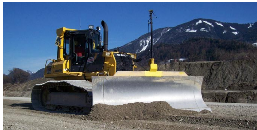
Spycharka z systemem 3D MC 2 może wykonać pracę z oczekiwaną dokładnością nawet w jednym przejeździe
