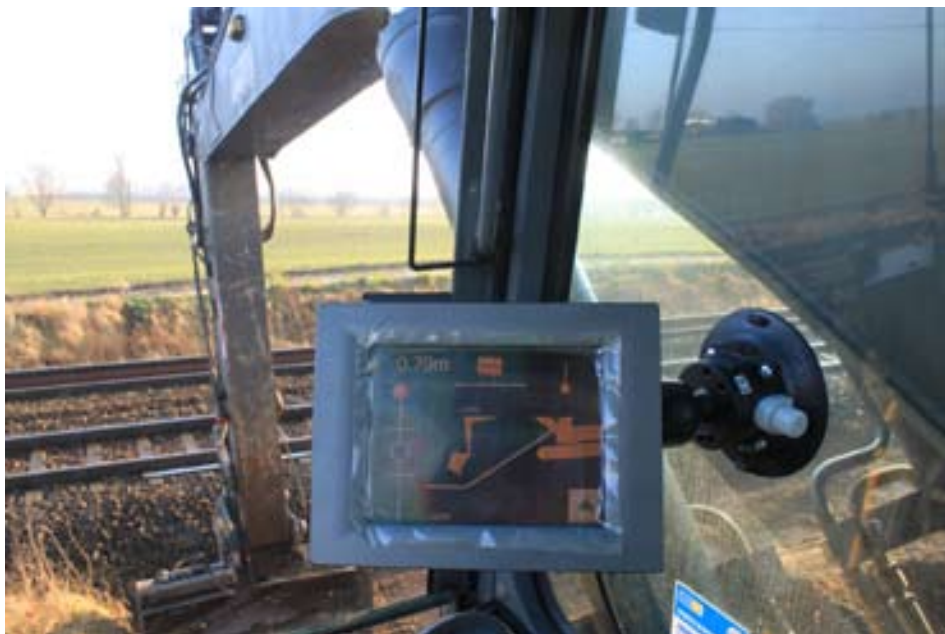
Każdy ruch łyżką prezentowany jest na ekranie wyświetlacza
