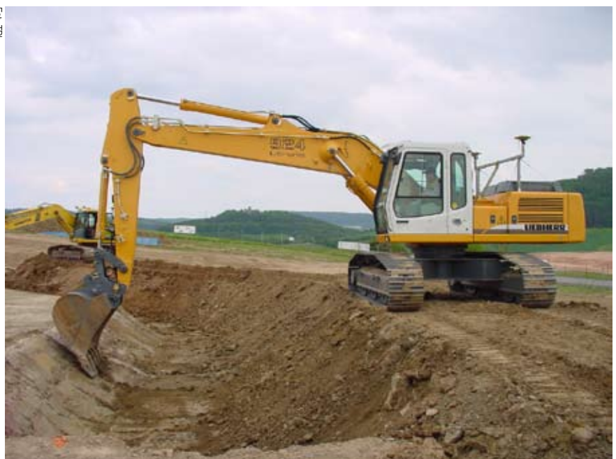
Maszyna z systemem 3DXi ma możliwość pracy na podstawie projektu cyfrowego
