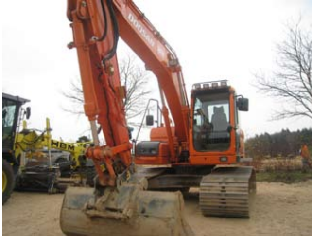
Koparka z systemem Topcon 2DXi – widoczne czujniki na ramieniu i panel w kabinie operatora
