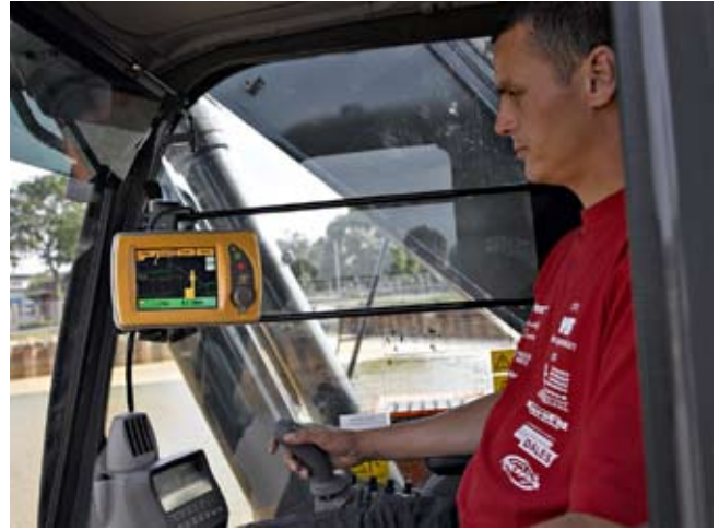
Koparka z systemem Topcon 2DXi – widoczne czujniki na ramieniu i panel w kabinie operatora
