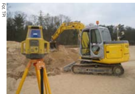
Koparka z bezprzewodowym system Topcon 2D Xi22
