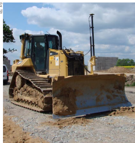
Spycharka z automatycznym systemem sterowania Topcon 3Dmc2 GPS
