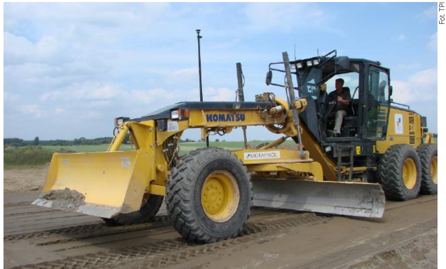
Równiarka z automatycznym systemem sterowania Topcon 3D LPS
