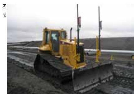
Spycharka wyposażona w system sterowania 2D i maszty manualne
