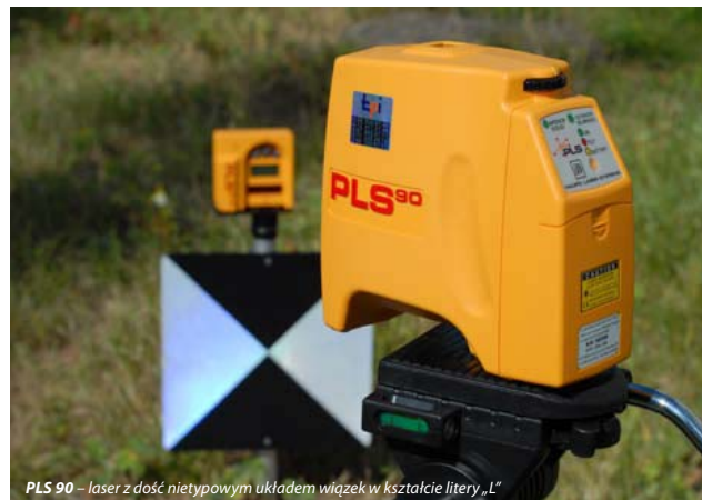
PLS 90 - laser z dość nietypowym układem wiązek w kształcie litery „L”
