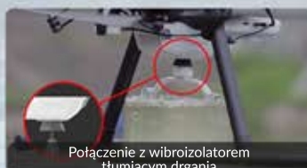
Połączenie z wibroizolatorem tłumiącym drgania
